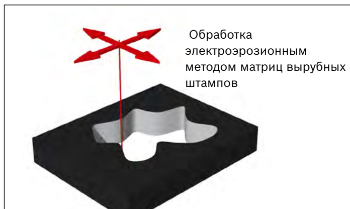
Проволочная электроэрозионная обработка
