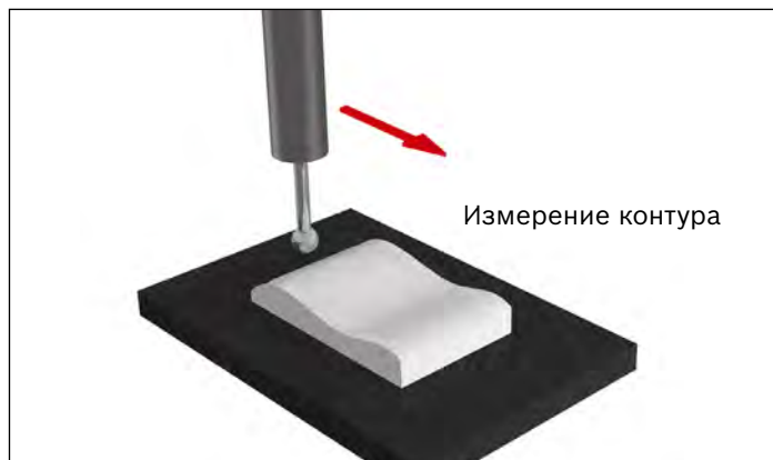
Координатно-измерительная машина 3D
