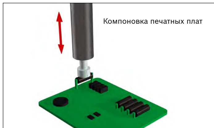
Установка автоматического монтажа электронных элементов на печатных платах
